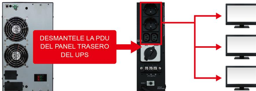
Después de que el módulo del enchufe de la PDU sea desmontado, la unidad del UPS estará disponible para el centro de servicio para su reparación.
